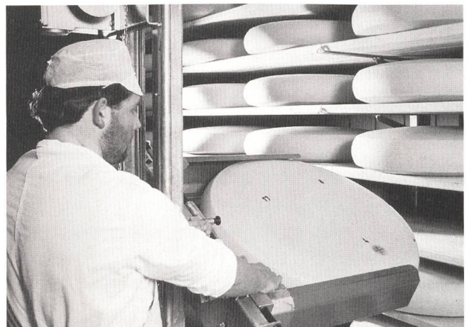
Käsepflege mit dem elektrisch betriebenen «Roboter». Damit werden die etwa zentnerschweren Emmentaler-Laibe aus den Gestellen gehoben und zurückgelegt. (Photo E. Rieben/Schweiz. Käseunion AG)
