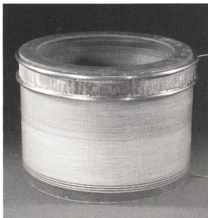
Bild 7 Einschaltvormagnetisierung für supraleitende Transformatoren (im Bild eine supraleitende Versuchsspule).
