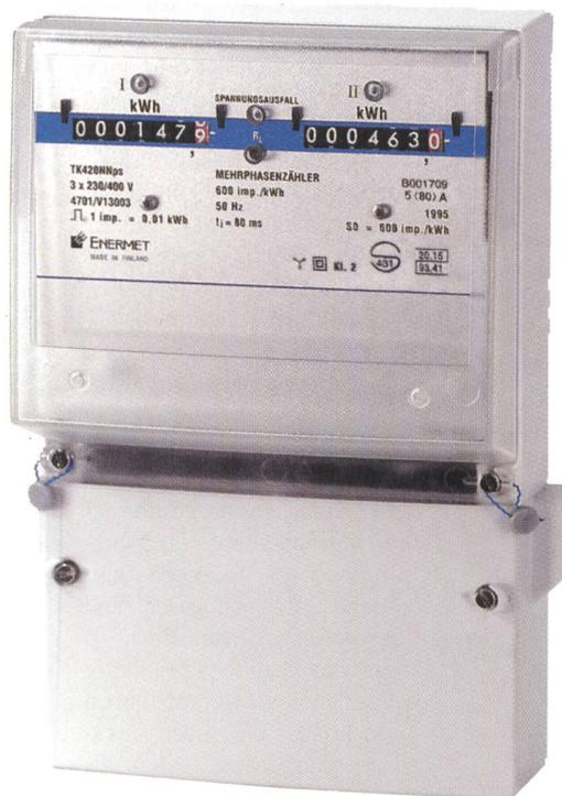
*Ce type de compteur est livrable en version simple ou double tarif, pour le raccordement direct ou indirect, pour la mesure de l'énergie active ou réactive, et pour les classes de précision 1 ou 2. Ces compteurs conviennent aussi bien à l'usage ménager qu'aux applications industrielles et sont équipés d'une interface de type S0.*
