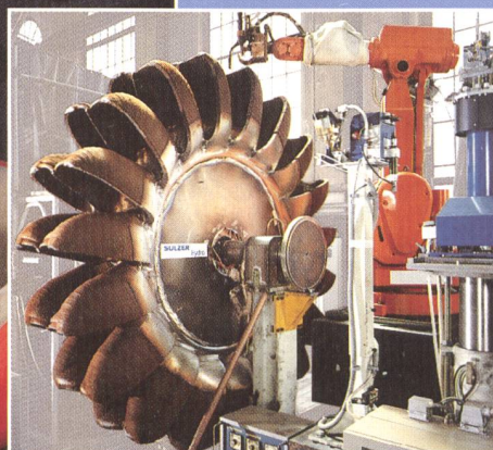
▲ Fertigung eines Pelton- Laufrades im MicroGuss- Verfahren
