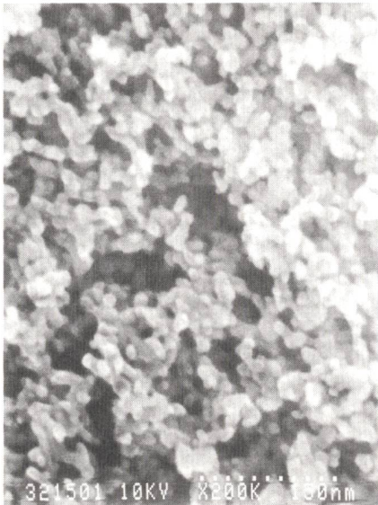
Bild 5 Rasterelektronenmikroskopische Aufnahme eines nanokristallinen TiO 2 -Filmes
