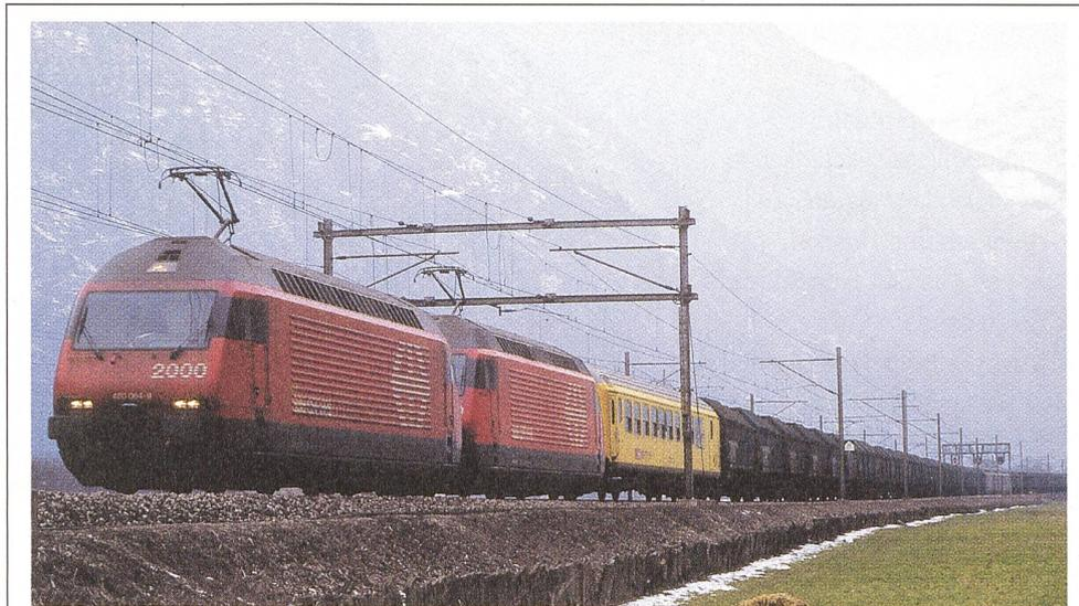
Testzug mit 3200 Tonnen am Gotthard, beim erfolgreich verlaufenen Versuch vom 12. Februar (Photo SBB).
