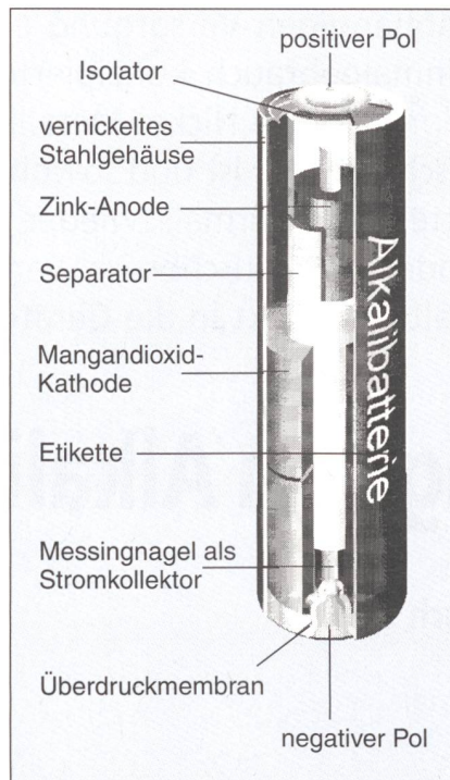
Bild 1 Prinzipieller Aufbau einer Alkalibatterie
