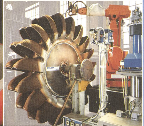
▲ Fertigung eines Pelton-Laufrades im MicroGuss-Verfahren
