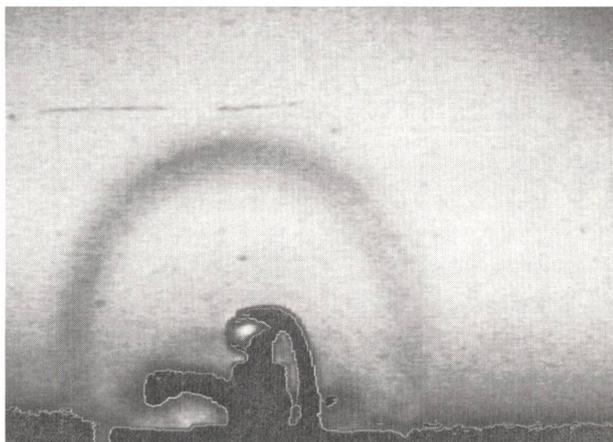
Bild 2 Explosion einer Blase mit Emission einer Schockwelle.
