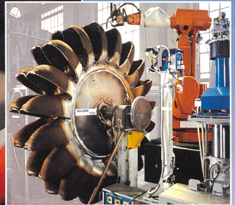
▲ Fertigung eines Pelton-Laufrades im MicroGuss-Verfahren
