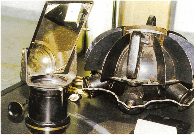
Episkop (Vorläufer des heutigen Hellraumprojektors) mit Kühlrippen zur Wärmeabfuhr der sechs Glühlampen
