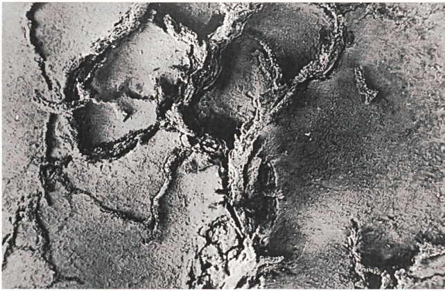
Bild 4 Grabende Erosion in einem SR-HTV
