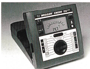
Multifunktionsmeter Megger CM 300
