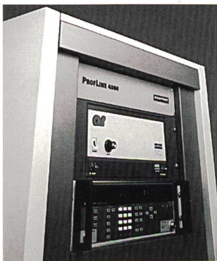
Das PC-gestützte EMV-Testsystem Proflin 4000 gemäss IEC 1000-4-6
