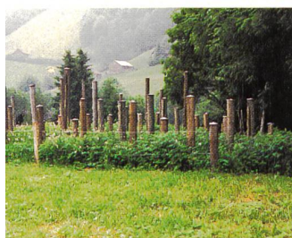
Champ d'essai pour les supports de ligne en bois: la «plantation de poteaux» de l'UCS à Starkenbach (SG).
