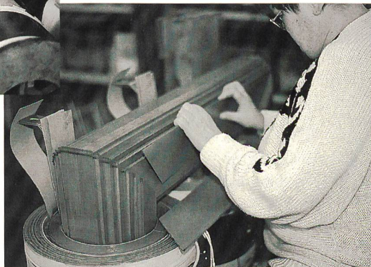
Bild 1 Transformatorenbau mit Maschine und Handarbeit
