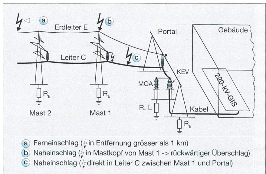
Bild 3 Simulation der Blitzeinschläge
