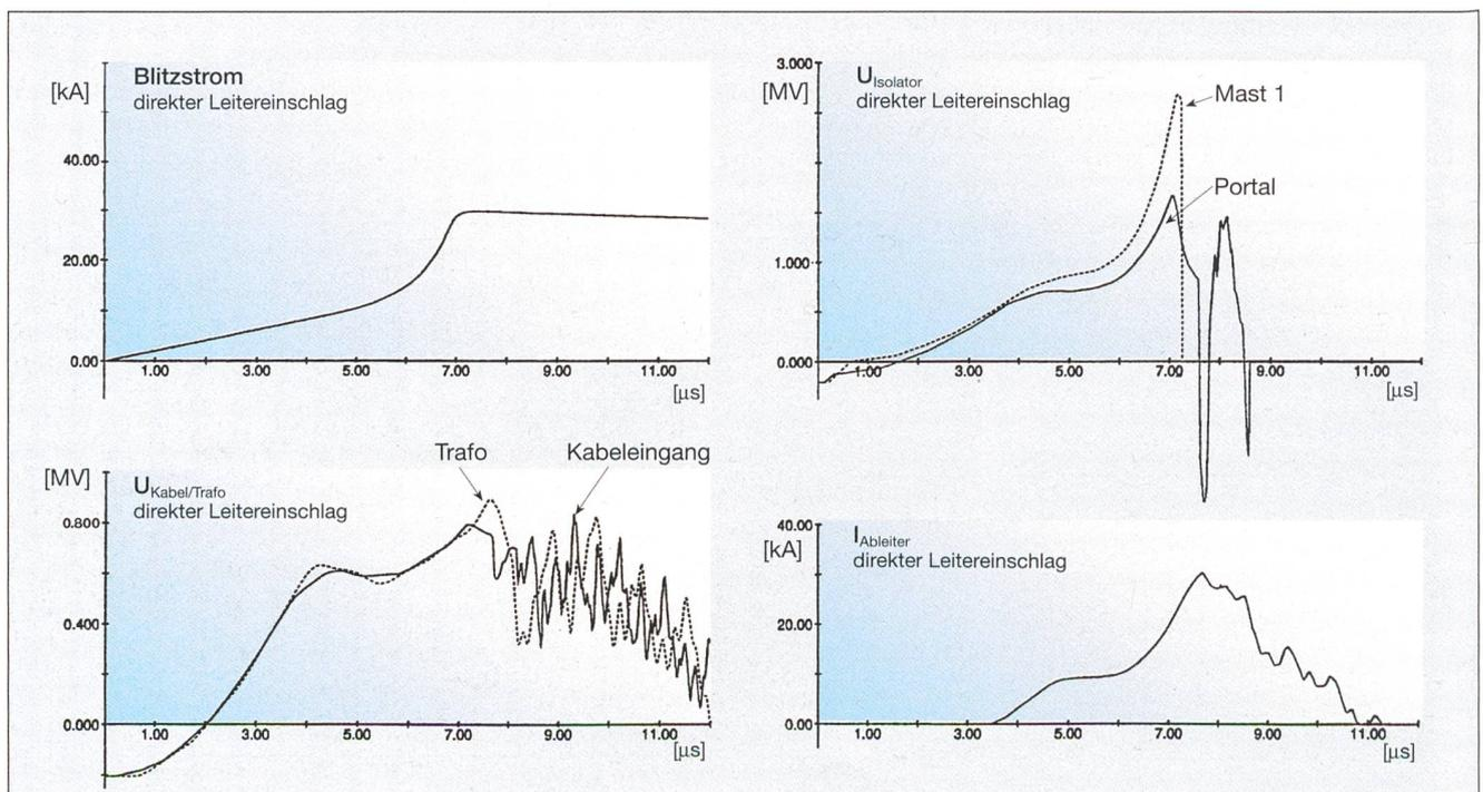
Bild 6 Direkteinschlag in Leiterseil der Phase C zwischen Portal und Mast 1
