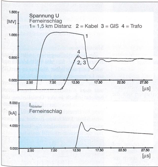
**Bild 4** Ferneinschlag auf der Freileitung
