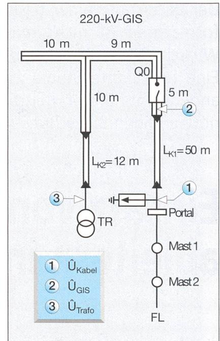
Bild 2 Reduziertes Anlagenschema
