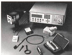
ESD- und EFT/Burst-EMV-Immunitätsprüfsystem
