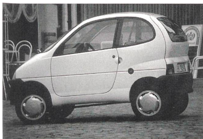
3 Der Ambra – von vielen als «Vorläufer» des Smart angesehen – ist mit einem Schweizer Asynchronantrieb ausgerüstet und wird mit verschiedenen Batterieversionen angeboten.
