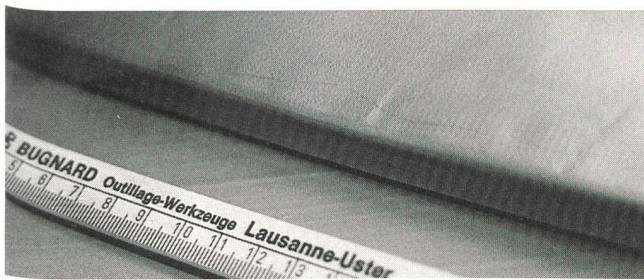
Fig. 4 Collerette de la pale numéro 1 avec revêtement de matériau composite
