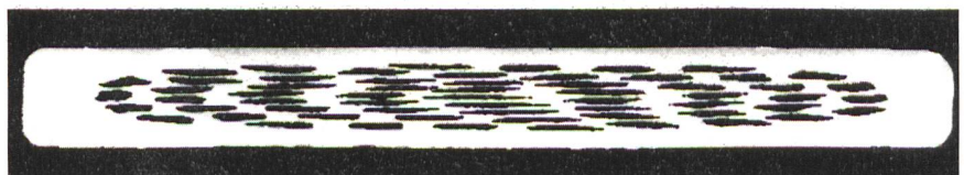
Figure 1 Section d'un ruban de Bi,Pb(2223) avec 37 filaments et un taux de supraconducteur de 25%
