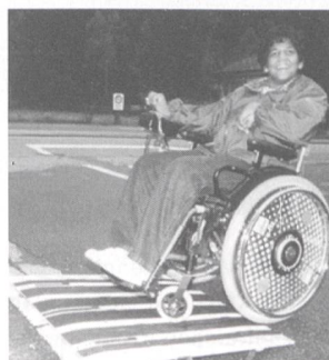
Une idée simple mais utile: rampe pliable pour les handicapés circulant en fauteuil roulant.
