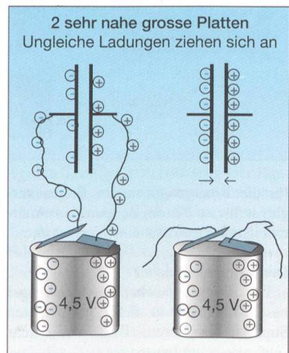
Bild 8 Funktionsprinzip eines Kondensators
