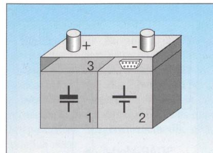
Bild 11 Die drei Grundelemente eines Super Accumulator Module (SAM)
