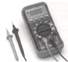
Multimeter BM 629 kann Temperaturen messen.
