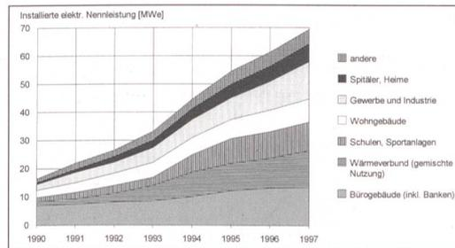
Bild 5 zeigt, haben die fossilen BHKW in den vergangenen Jahren eine starke Zunahme erfahren. Die wichtigsten Einsatzgebiete sind Bürogebäude, Gewerbe- und Industriebetriebe, Schulen und Sportanlagen sowie Nahwärmeverbundnetze.
