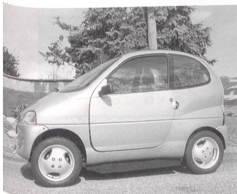
Ambra: Der von der Schweizer Firma Scholl Sun Power entwickelte Asynchronantrieb verleiht dem aus Frankreich stammenden Fahrzeug mit Aluminiumrahmen und Kunststoffkarosserie gute Fahrleistungen. Das nur 2,5 m lange Fahrzeug bietet Platz für zwei Personen, viel Kopffreiheit und einen beachtlichen Gepäckraum. Es können verschiedene Batterietypen eingesetzt werden.
