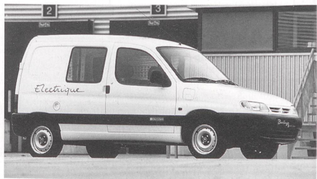
Die technisch weitgehend identischen Modelle Partner von Peugeot (links) und Berlingo von Citroën (rechts) des PSA-Konzerns sind mit ähnlicher Antriebstechnik wie die Personenwagen-Modelle 106 bzw. Saxo électrique ausgerüstet, die aber für das höhere Gesamtgewicht etwas verstärkt und mit einigen zusätzlichen Batterien ergänzt wurden. Dank günstiger Platzierung der Batterien unter dem Laderaum ist der Nutzraum der Elektroversionen praktisch gleich wie bei den konventionell angetriebenen Fahrzeugen. Auch diese Modelle verfügen über eine automatische Parkbremse. Für den Kaufentscheid vieler Interessenten hilfreich dürfte das neue Angebot von Peugeot zur Batteriemiete sein.
