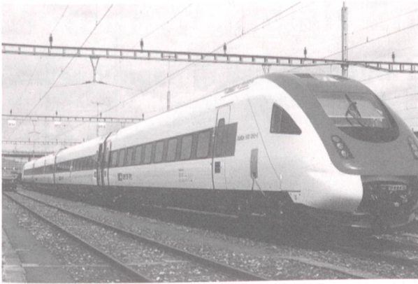
Bild 9 Intercity-Neigezug ICN der SBB mit Triebwagen ( v_{\max} = 200 \text{ km/h} , 355 t, 457 Sitzplätze) (Bild: Adranz)
