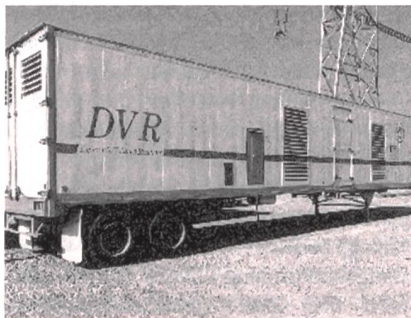
Bild 5 Mobiler 2 MVA Sipcon DVR
