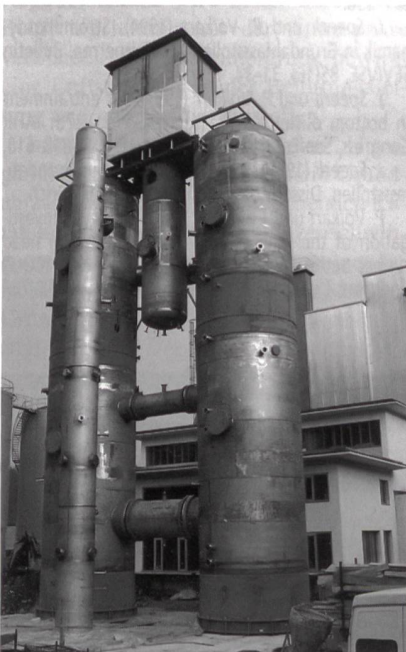
Bilder 1 bis 3 Bauphasen der Versuchsanlage PANDA. Das mechanische Grundgerüst für die Versuchsanlage PANDA bildet das Behältersystem. Zylindrische Druckbehälter (10 bar/200°C) stellen Reaktordruckbehälter und Sicherheitsbehälter einer Reaktoranlage dar. Ganz oben sind die kubischen Kühlbecken für die passive Nachwärmeabfuhr zu sehen. Um die Behälteranlage herum wurde eine Stahlbaute errichtet.
