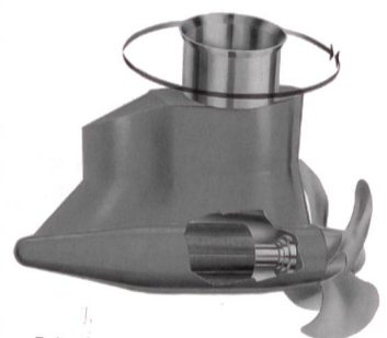
Beim Azipod-Antrieb von ABB befindet sich ein Drehstrommotor in einer unter dem Heck hängenden Gondel, die sich um 360° frei drehen lässt.
