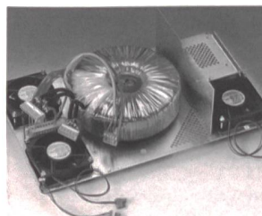
Netzteil mit Ringkerntrafo
