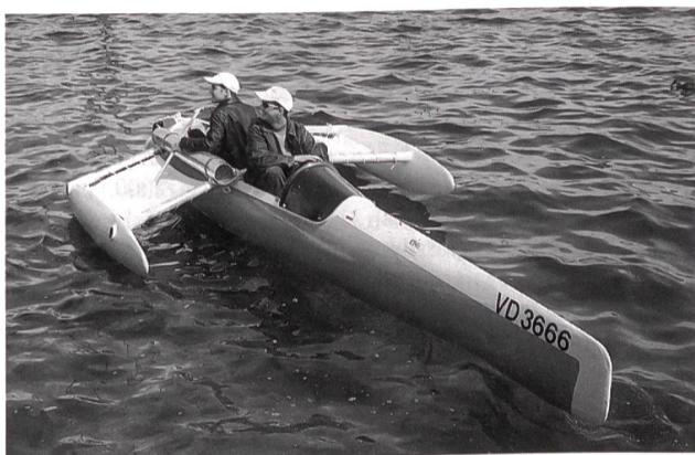
Eine 300-Watt-Brennstoffzelle treibt den Trimaran: Zwei Ingenieurstudenten aus Yverdon gleiten lautlos übers Wasser (Fotos: Ulf Bossel).
