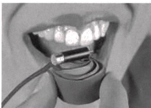
Hat auf einer Praline Platz: Motor mit 6 mm Durchmesser.
