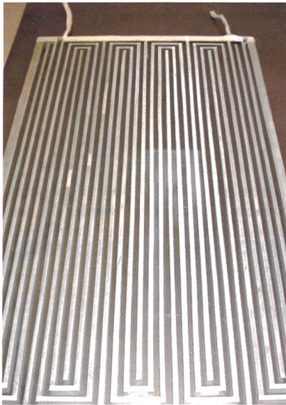
Bild 2 Thermisch gespritzte Alu-Heizleiter auf Glassubstrat als Heizplatte
