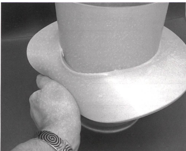
Bild 14 Künstlich erzeugte vollständige Ablösung des Schirms auf einem Segment, das etwa 20% des Umfangs einnimmt
