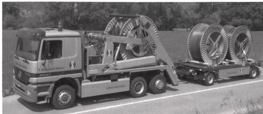
Bild 7 Geländegängiges Zugfahrzeug mit Auf- und Abwickelvorrichtung für Spulendurchmesser von 1650 bis 3400 mm (Kabeltransporte bis 12 t)
