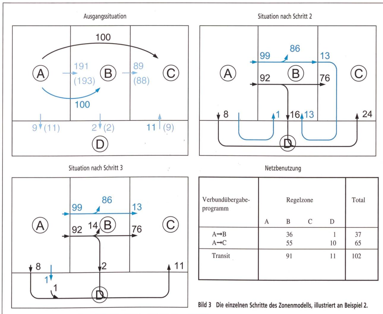
Bild 3 Die einzelnen Schritte des Zonenmodells, illustriert an Beispiel 2.
