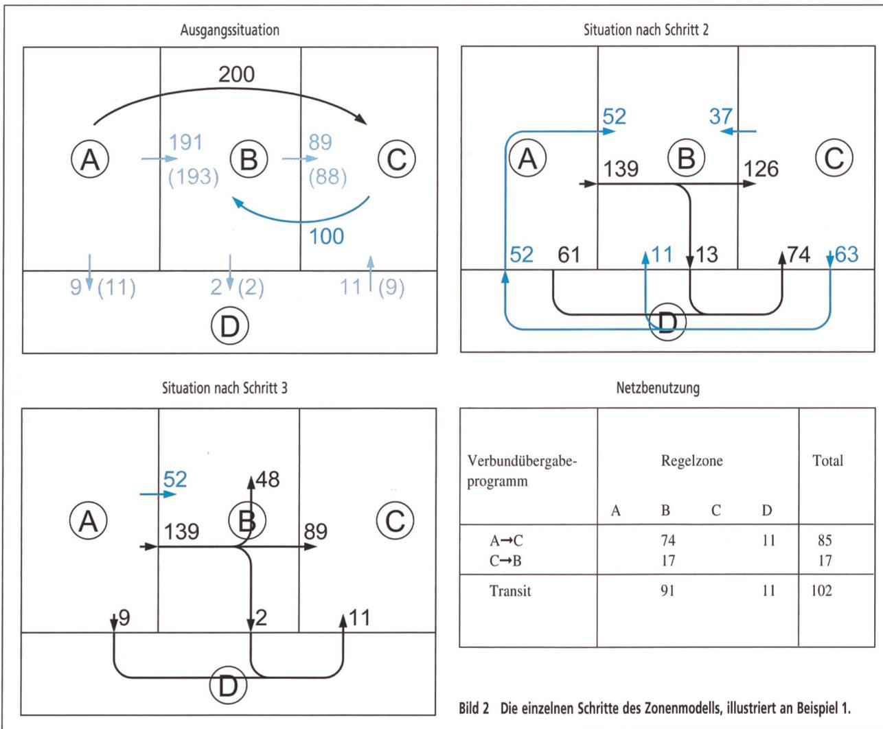
Bild 2 Die einzelnen Schritte des Zonenmodells, illustriert an Beispiel 1.
