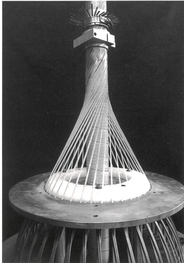
Bild 3 Statischer Verseilkopf mit den am oberen Ende des Trägerrohres fixierten und zwecks Strom-einspeisung am Rohrkopf verlöteten 40 Bi-2223-Bändern einer Lage.
