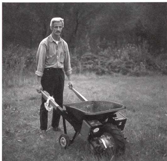
Ein weiterer Gewinner war Marco Gada-Barenco (3. Preis, 3. Kategorie). Mit seiner Erfindung, einer elektrisch betriebenen Schubkarre, können Zuladungen bis zu 100 Kilo auf steilen Stücken transportiert werden.
