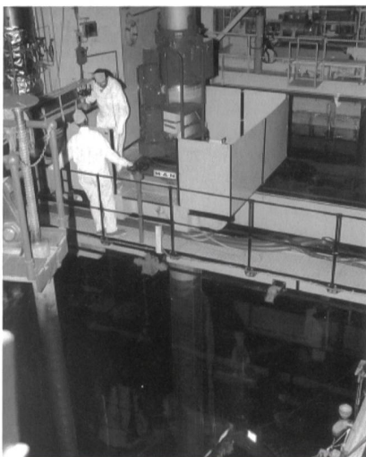
Untersuchung des Reaktordruckgefässes mit Ultraschall.
