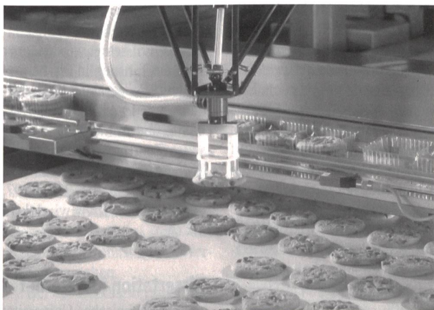
Détail d'un préhenseur pour biscuits
