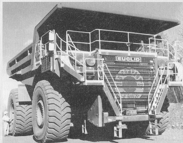
Lastwagen mit 2,2 Megawatt Antriebsleistung.
