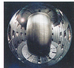
Stabiler Plasmastrom im Innern des Lausanner Tokamak: zwei Sekunden bei hundert Millionen Grad
