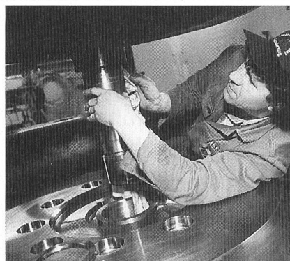
Montage der Laufradwelle.
