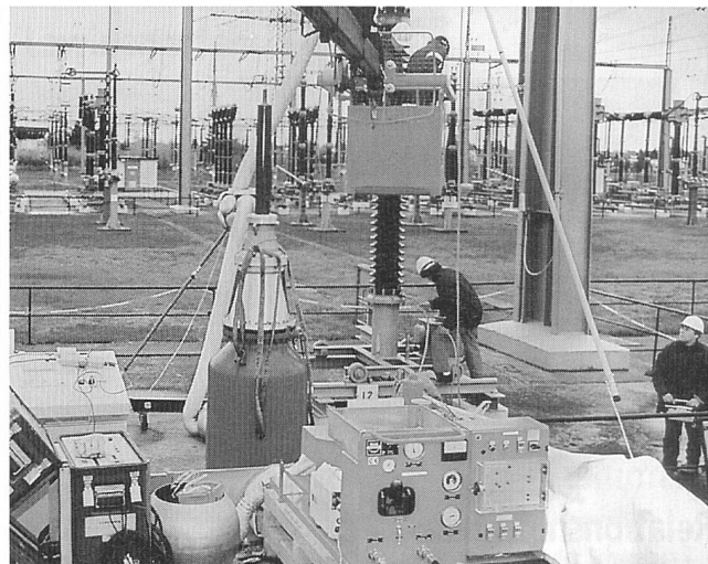
Die Auswahl der richtigen Diagnoseverfahren ist entscheidend für die Zustandsbewertung (im Bild: Überprüfung von Spannungswandlern in einem 380-kV-Netz).
