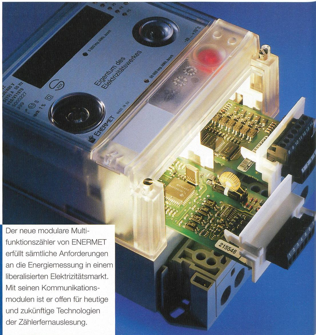
Der neue modulare Multifunktionszähler von ENERMET erfüllt sämtliche Anforderungen an die Energiemessung in einem liberalisierten Elektrizitätsmarkt. Mit seinen Kommunikationsmodulen ist er offen für heutige und zukünftige Technologien der Zählerfernauslesung.
