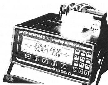
Das bewährte, robuste, vielseitige, tragbare und preiswerte System für das Messen, Registrieren und Beurteilen von Belastung, Verbrauch und Oberschwingungsgehalt elektrischer Netze.
