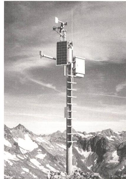
Bild 1 Automatische Imis-Messstation
