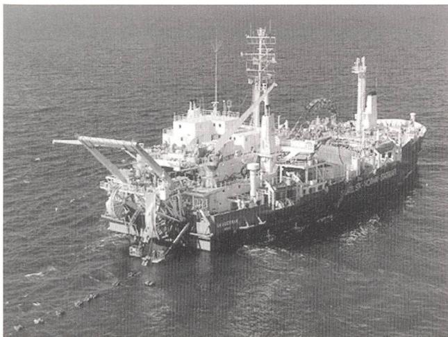
Spezialschiff für Unterwasserkabel (Bild Alcatel).
