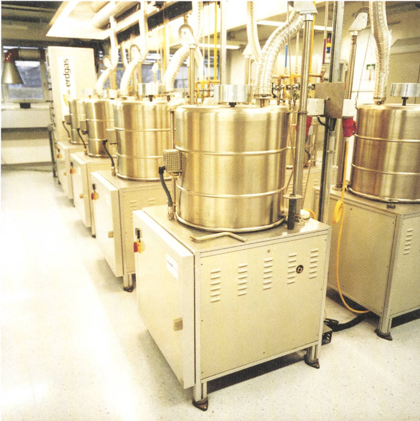
Infrastruktur zur Langzeitqualifizierung der metallischen und keramischen Komponenten bei hohen Temperaturen (900 °C).
